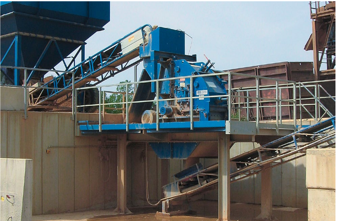
Einsatz eines BHS Prallbrechers vom Typ PB 0806 zur Zerkleinerung von Kiesüberkorn von 32 bis 250 mm zur Herstellung verkaufsfähiger Splitte.
