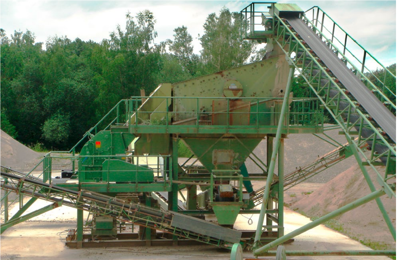
BHS Prallmühle vom Typ PM 0806 zum Brechen von Betonrecycling und Kiesüberkorn. Im Zuge einer Modernisierung der Anlage ersetzt die Prallmühle einen Backenbrecher.
